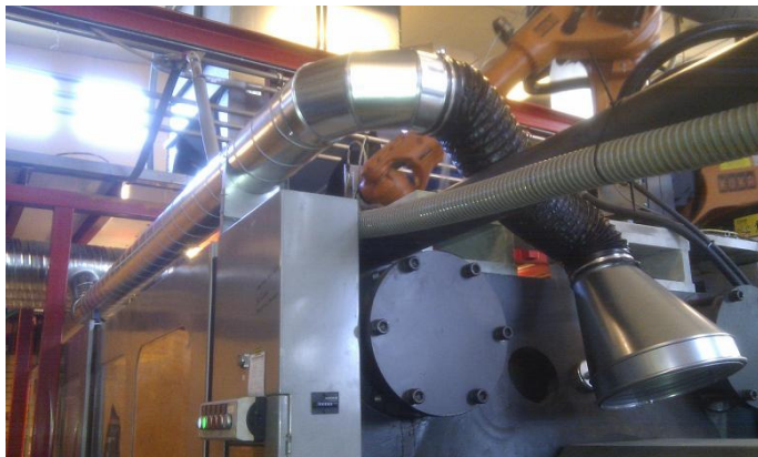
Punktudsugning ved støbemaskine - sugehoved på magnet.
