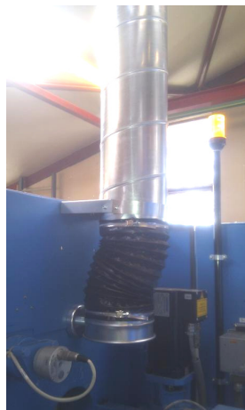
Punktudsugning ved støbemaskine - sugehoved på magnet.
