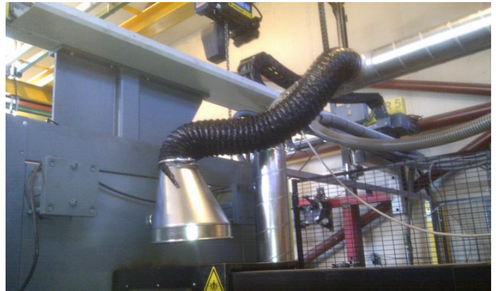
Punktudsugning ved støbemaskine - sugehoved på magnet.
