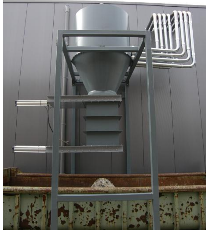
Udladning af materiale sker kontinuerligt efter en forud programmeret tid - i dette tilfælde for hver 8. minut.
