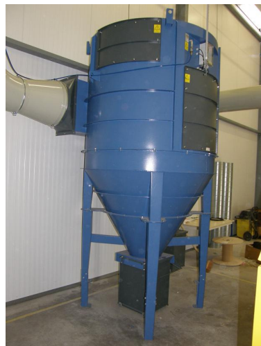
Komplet filteranlæg med automatisk filterrensning. Opsamling af det fine støv sker i stor spand på 120 ltr. under filteranlæg. Anlægget har et filterareal på i alt 130 m 2 .
